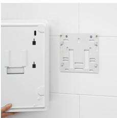
Die Satino-Montageplatte macht die robusten Spender zu einer dauerhaft sauberen und zugleich flexiblen Lösung: Montageplatte anhalten, Bohrlöcher markieren und bohren, Montageplatte anschrauben und Satino-Spender einhängen. Dank Montageplatte können vorhandene Bohrlöcher wieder genutzt werden, erneutes Bohren wird überflüssig. Wird der Spender zum Beispiel bei einem Update oder im Falle von Vandalismus ausgetauscht, bleibt die Montageplatte einfach an der Wand.
